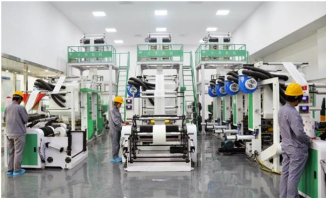
一条生产线布置了双螺杆改性生产设备，可满足不同制品应用场景需求，改性生产线总长 40 米，年产改性料约 2000 吨。另外一条生产线，有三台吹膜制袋机，改性料通过吹膜、全自动印刷、切袋制成可降解塑料袋，三台吹膜机年产 1500 吨左右，相当于 0.75 亿个可降解塑料袋。另外，制品车间还安装了一台全自动正负压吸塑机，利用改性的片材生产可降解塑料餐盒餐具，日产达 2 到 3 万套。
