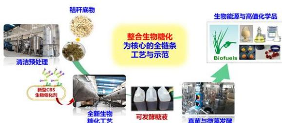
目前，基于构建的第三代 CBS 生物催化剂，代谢物组学研究组通过与企业的合作已经建成百吨级秸秆糖化中试示范，将进一步解决中试放大过程中的技术问题，开展 CBS 过程的生产成本估算和进一步的技术优化。通过研究人员的不懈努力，CBS 工艺最终有望以具有经济实用性和可持续性的方式将木质纤维素生物转化带入实际的工业应用中，从而极大地促进木质纤维素生物质资源的大规模应用。
