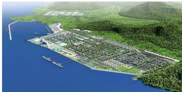
该项目将建于大连长兴岛经济区石油化工园区恒力石化(大连)有限公司现有厂区内;总用地面积 37847.9 平方米,投资金额 80210 万元,施工工期为 12 个月。本项目该工艺采用的是直接酯化法、连续缩聚工艺生产技术,以己二酸(AA)、对苯二甲酸(PTA)和 1,4 丁二醇(BDO)为原料,在钛系催化剂(钛酸四丁酯)的作用下,直接酯化脱水反应生产单体己二酸丁二醇酯(BHAT)/对苯二甲酸丁二醇酯(BHBT),再缩聚/共聚为最终产品 PBAT 生物可降解材料切片。建成具有 15 万吨 PBAT 产能,副产品 THF 产能 0.8763 万吨。
