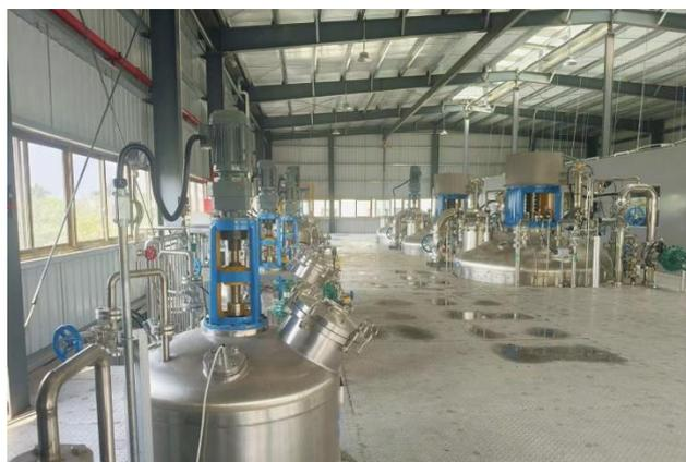
此次技改基于具有自主知识产权的代谢改造基因工程菌，利用公司迭代开发的 PHA 高密度发酵工艺，并通过引入全新自主设计的 60 立方米发酵罐和配套半智能化发酵控制系统等关键技术，使得 PHA 发酵周期缩短超 10%，发酵效率提升 25%，单位能耗降低 22%，生产成本下降 18%，单罐年产能超 700 吨。
