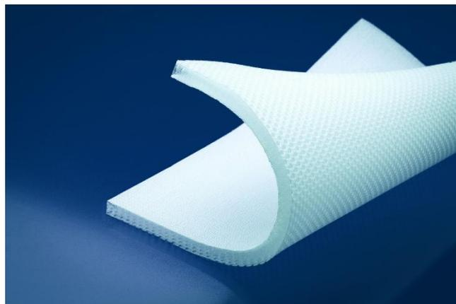
间隔织物是一种创新材料，以其透气性、缓冲性和多功能性而闻名。与传统的二维织物不同，间隔织物由两层独立的织物用单丝连接而成，在两层之间形成透气的三维“微气候”。这种独特的结构允许热量和蒸汽从身体排出，同时使冷空气在透气层中循环，从而确保最佳的温度控制和最大的空气循环。
