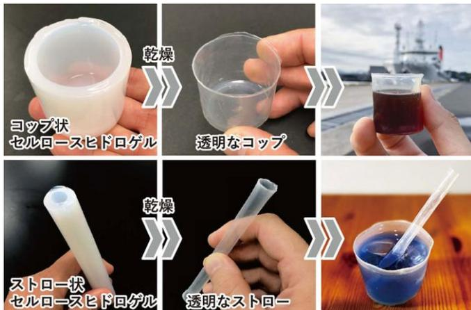
虽然用这种材料制成的杯子在三小时后会出现轻微漏水，但添加植物基树脂涂层后，材料接触角超 90 度，提高了其保留液体的能力，实现透光防水双功能。
