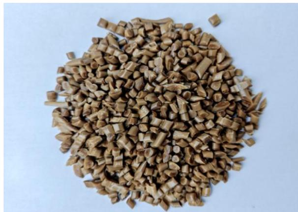
PGA 是一种具有良好生物降解性和生物相容性的脂肪族聚酯类高分子材料，具有高机械性能、高阻隔性
