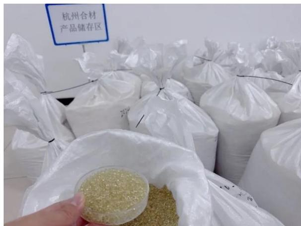
二氧化碳基聚碳酸酯材料由二氧化碳和环氧丙烷在催化剂作用下共聚而成，商品名为聚碳酸亚丙酯 (PPC)。PPC 具有优异的生物降解性能，同时兼具卓越的水氧阻隔性，柔韧性好，非常适用于高阻隔性包装材料以及地膜等下游应用场景。
