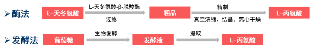
图 6：丙氨酸的酶法和生物发酵法生产工艺
