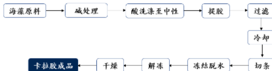
图：卡拉胶制备流程示意图
