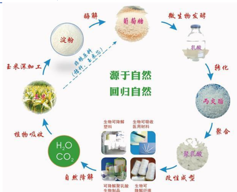
图 5：聚乳酸材料的碳循环示意图
