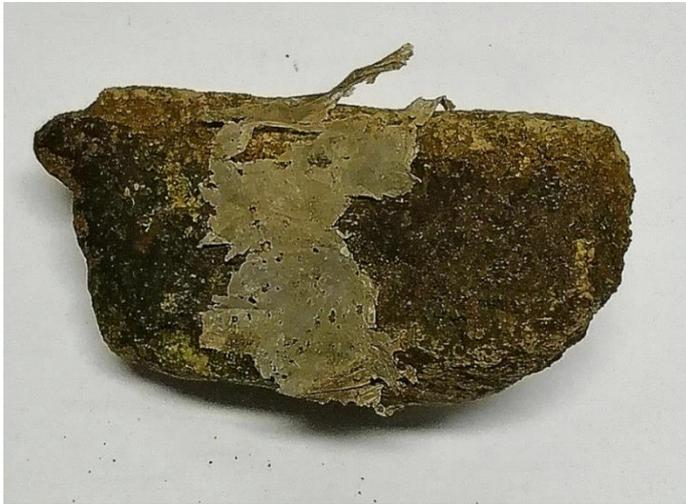
当研究人员用光谱仪器观察塑料-岩石组合时，他们发现，聚乙烯薄膜表面的碳原子在氧原子的帮助下与岩石中的硅形成了化学键 (C-O-Si)。侯德义说，这种结合可能是由太阳紫外线驱动的，或者是由塑料岩石上一个微生物群落的代谢活动驱动的。此外，研究发现，聚丙烯薄膜似乎是通过物理作用而不是化学键附着于岩石上的。
